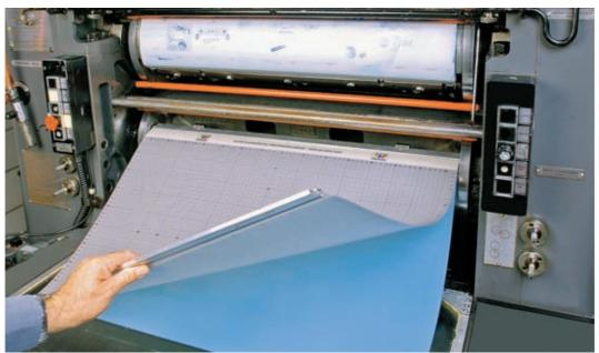
1d Zylinder vorwärts drehen und die hintere Spannschiene in die Halterung des Gummizylinders einhängen. Damit die Trägerfolie richtig montiert ist, müssen die Spannschienen genau parallel zur Zylinderkante positioniert werden. **WICHTIG für das Anziehen der Trägerfolie:** Trägerfolie straff, aber nicht zu stark auf den Zylinder spannen. Folie vor jedem Wiedereinspannen überprüfen.
